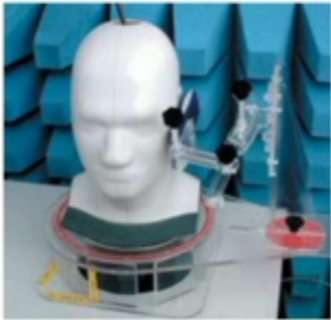
fantôme" dans lequel une sonde mesure le niveau d'exposition aux radiofréquences.
